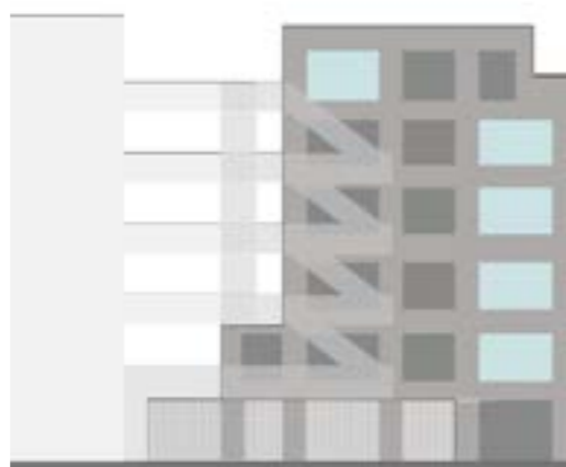
5. KOPGEVELS De kopgevels worden op dezelfde manier als de westgevel opgezet. Het grid en ritme van de westgevel loopt overhoeks door.
